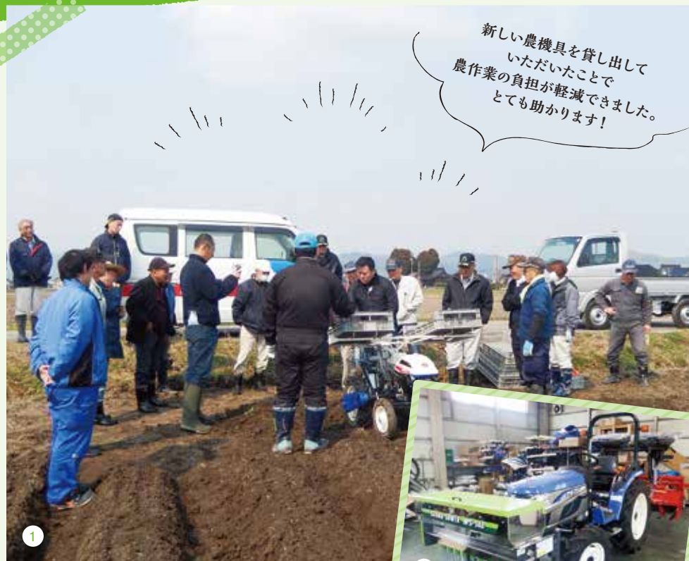
1) 馬鈴薯種子の自動定植歩行型の自動定植機 2) トラクターにセットした畝立・畦形成機
