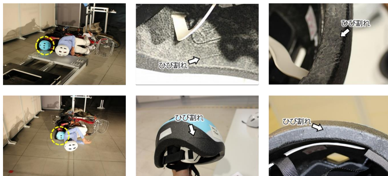
図 14 子供ダミーのヘルメットの損傷状況(上段:実験番号 2[凸路面], 下段:実験番号 1[平坦路面])
