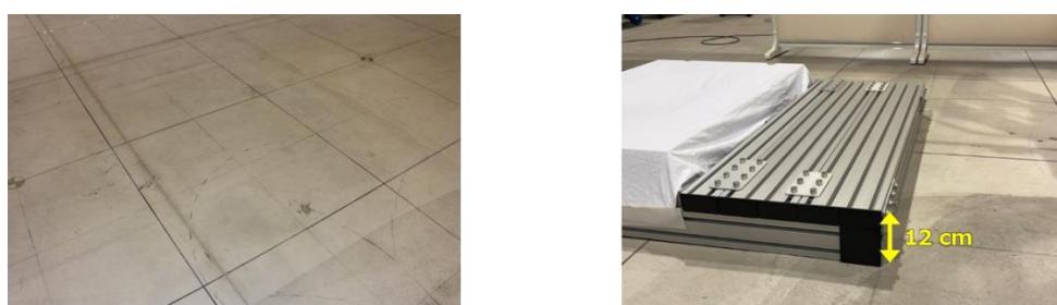
図7 路面形状 [左側:コンクリート製, 右側(縁石相当):アルミニウム製]
