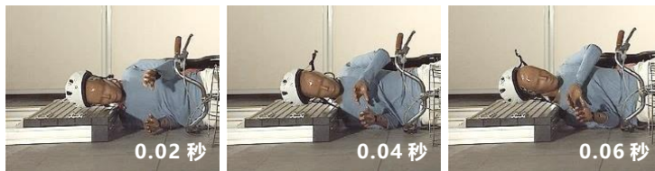
図 18 女性ダミーの衝突瞬間の挙動
